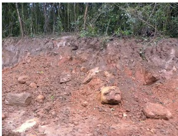
Foto 5.3-71: Detalhe de alteração de rochas basálticas, com característica heterogênea; conduzindo à formação de blocos e matacões em meio ao solo, gerando uma variação da condição de escavabilidade local e risco de instabilizações localizadas. Registro em talude lateral a via de acesso, na região de Colônia Santa Helena, município de União da Vitória/PR. Coord.: 22 J 506384 m E 7128585 m S.
