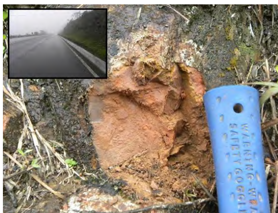
Figura 5.3-7: Caracterização de traquito saprolitizado; rocha vulcânica, de textura afanítica, de aspecto maciço, compacta, correlacionada à litofácies de traquito e quartzo-traquito da Formação Campo Alegre, observada em talude nas margens da BR 280 (ver detalhe), na região de Granja Rocha, município de São Bento do Sul/SC. Coord.: 22 J 662032 m E 7085659 m S.
