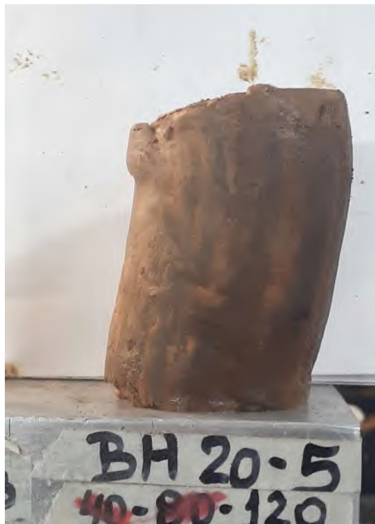
Fin de ensayos triaxiales CIUC escalonados. Muestra BH016 – 5 y BH20-5.
