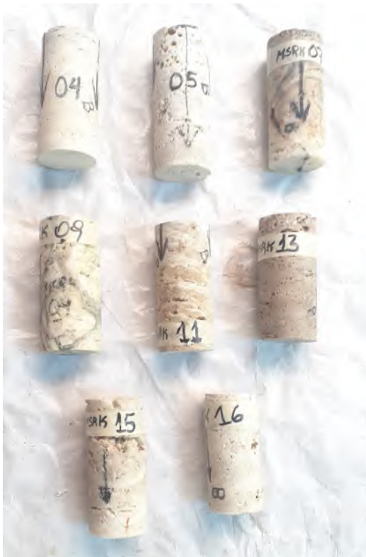
Ensayo de compresión no confinada. Muestras preparadas previa a ensayo.
