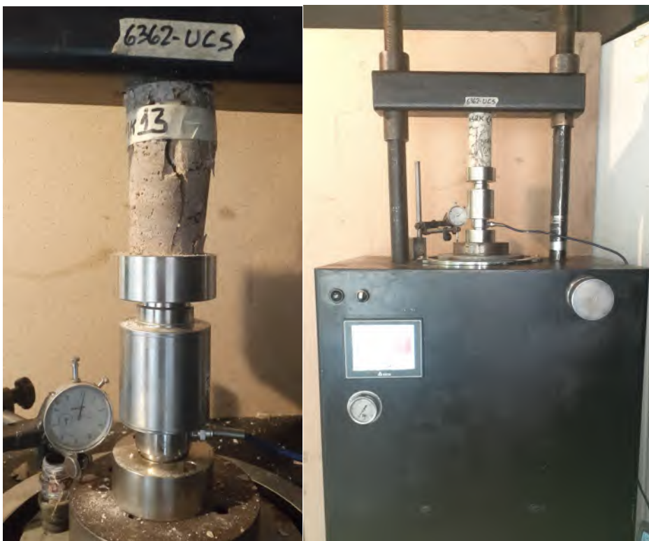
Ensayo de compresión no confinada. Pórtico de carga y muestra en rotura.
