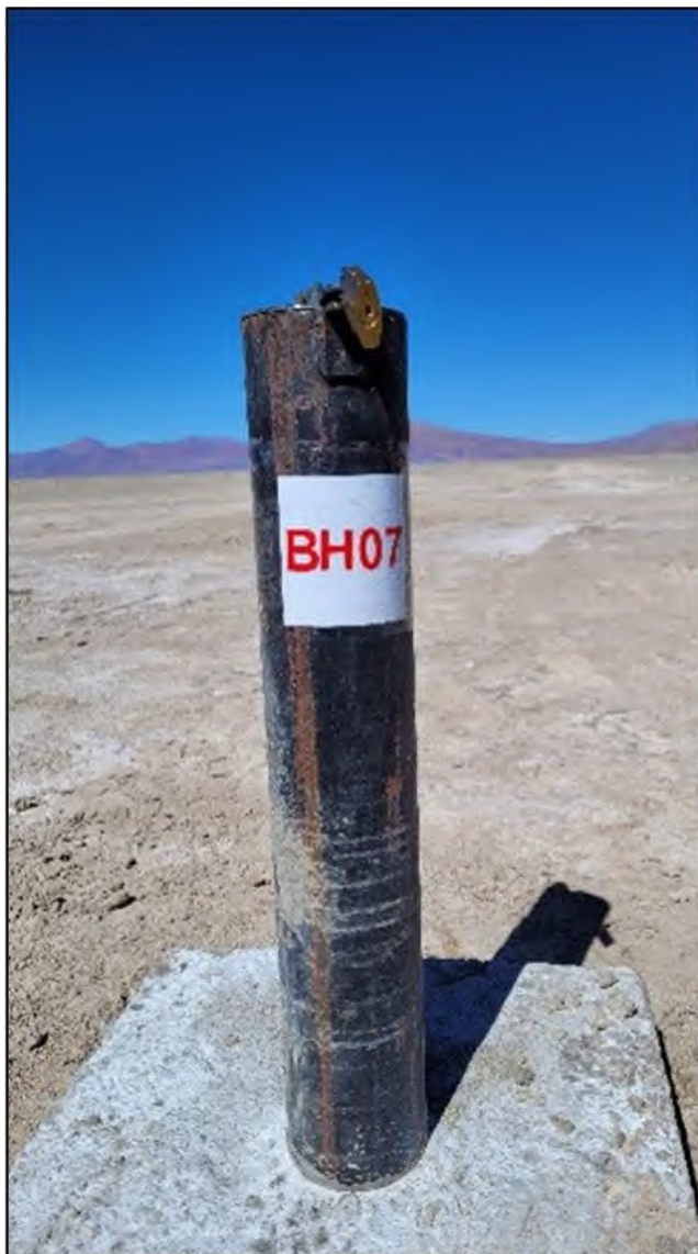
Figura 8-1: Tubo metálico de superficie en la perforación BH-07
