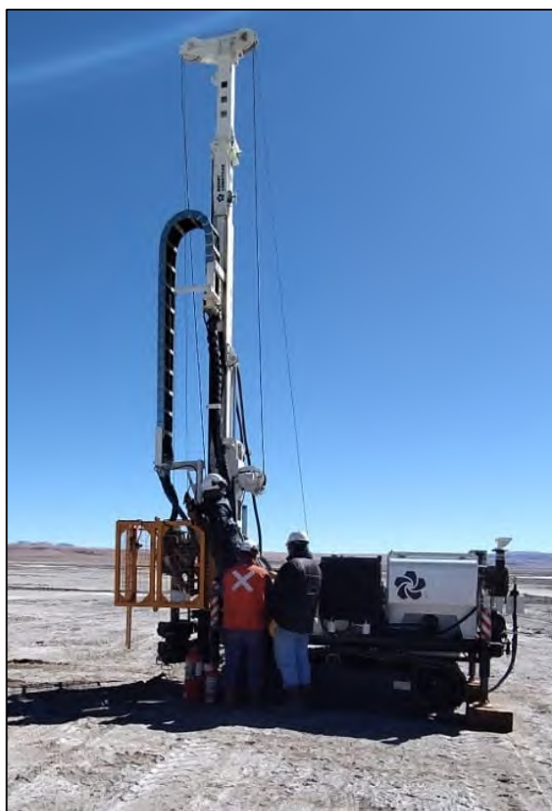
Figura 3-3: Máquina perforadora utilizada para la ejecución de los sondeos
