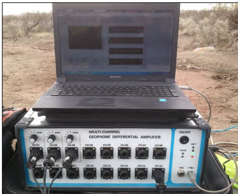
Figura 4-2: Hardware de adquisición de datos y PC portátil.
