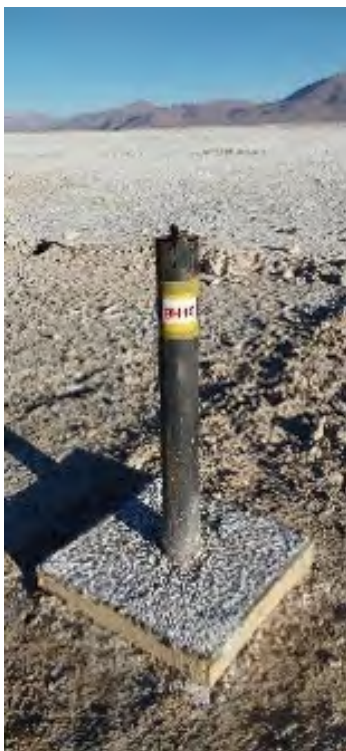
Figura 8-1: Imagen del tubo metálico de superficie y dado de hormigón
