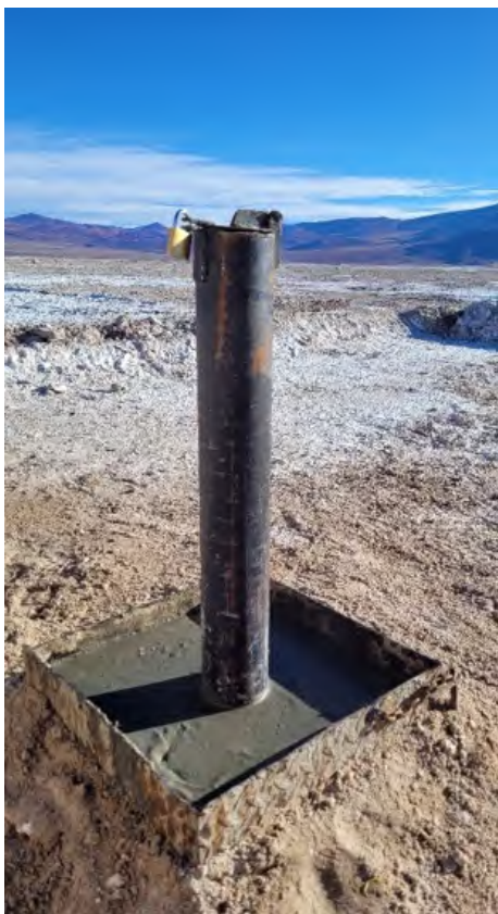
Figura 8-1: Imagen del tubo metálico de superficie y dado de hormigón
