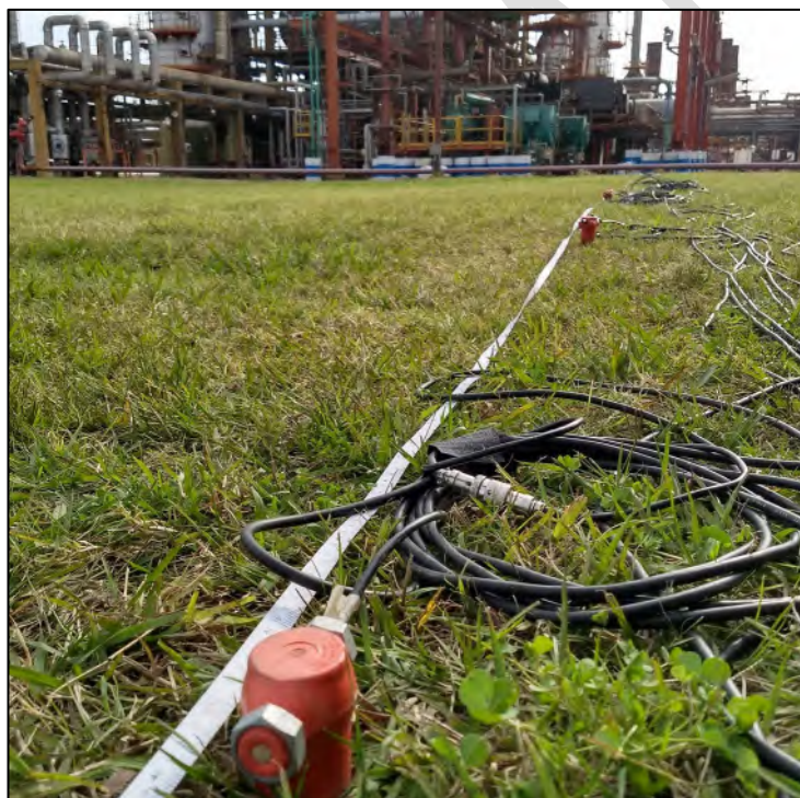
Figura 4-3: Cables conductores blindados, geófonos de baja frecuencia y disco impacto
