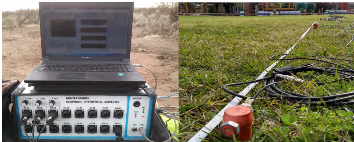
Figura 2. Equipo de trabajo: i) hardware de adquisición de datos, ii) PC portátil, iii) cables conductores blindados, iv) geófonos de baja frecuencia, v) masa de boleo, vi) disco de impacto.
