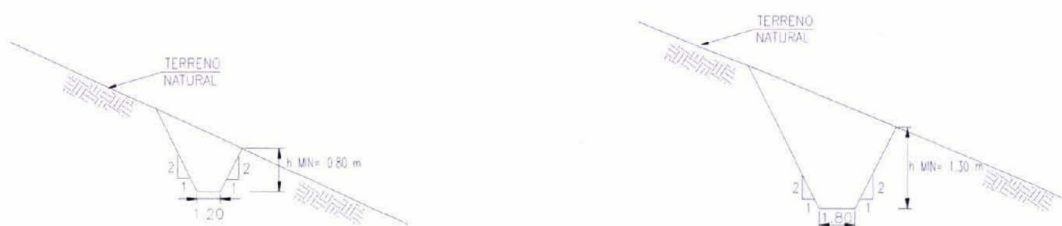
Figura 4.3. Sección Típica Canales de Desvío
