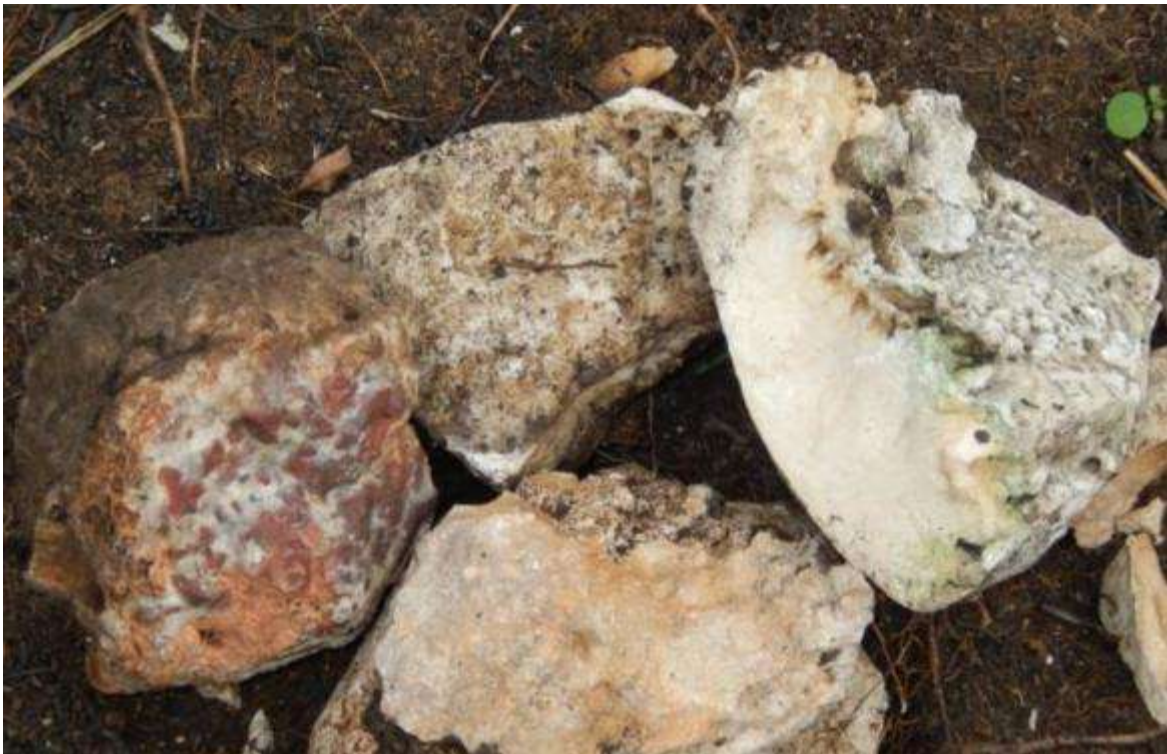
Gambar III-58 Batuan Kalkarenit yang Terbentuk Dari Proses Pengendapan Kembali Batu Gamping Dengan Ukuran Butir Batuan Berupa Pasir atau Arenit dan Endapan Haematit yang Umum Ditemukan di Kawasan Karst.
