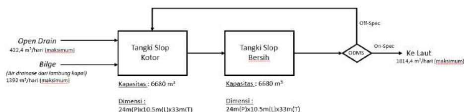
Gambar II-62. Pengolahan Air Limbah Berminyak di Slop Tank System
