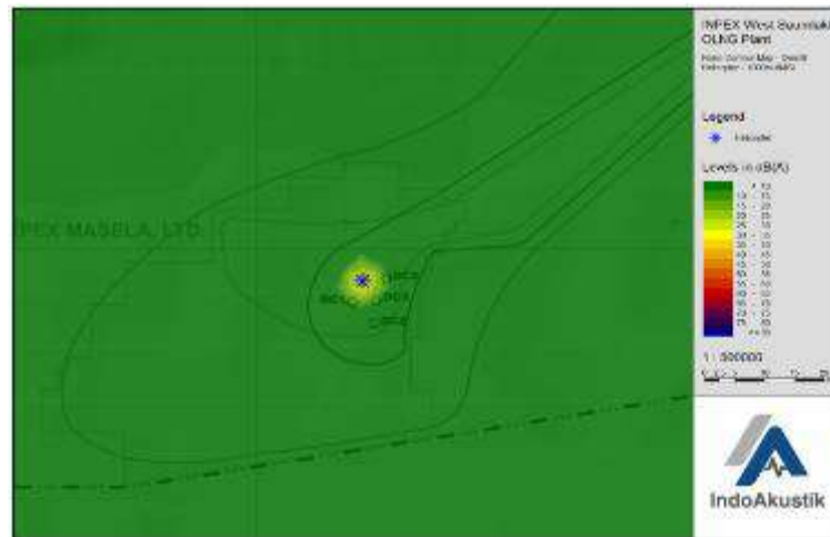
Gambar VI-8. Kontur Kebisingan pada Transportasi Helikopter di Area FPSO (dBA)
