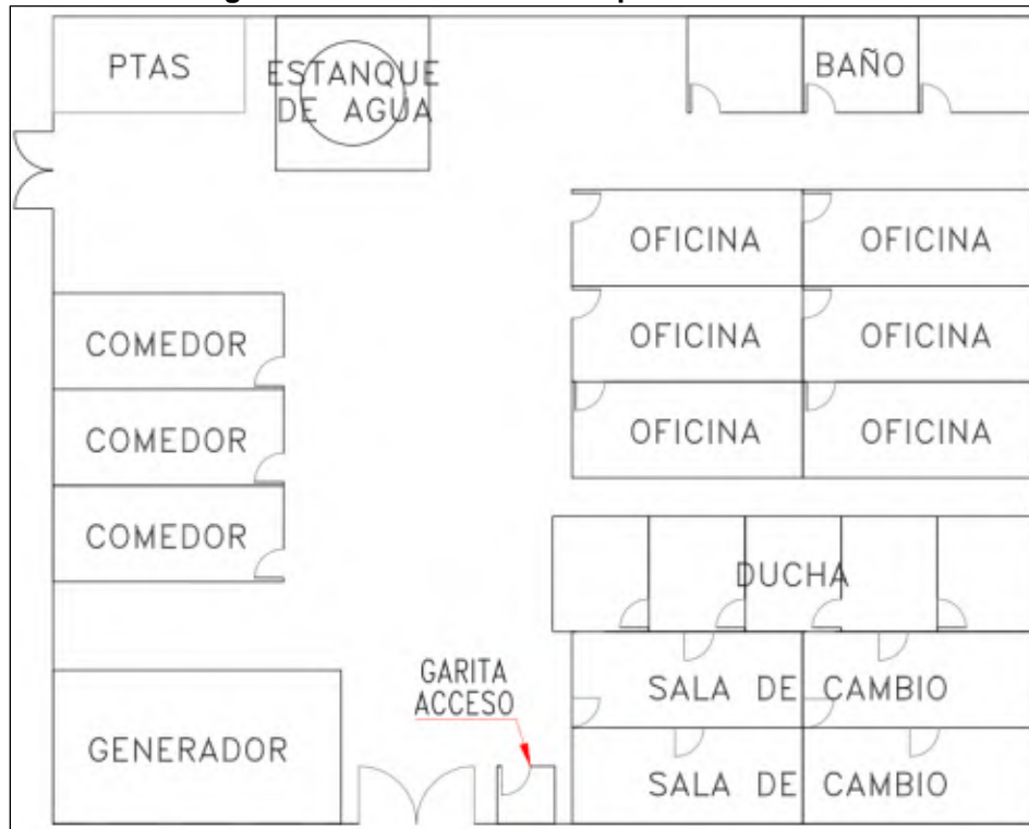
Figura N° 1.5.3.44. Instalación para Contratistas
