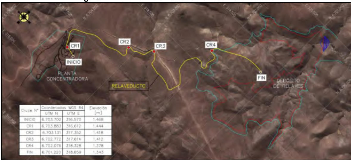
Figura N° 1.5.3.48. Atravesos de Cauce Relaveducto
