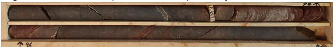
Figura N° 3.1.6.17 Unidad B4 (Arenisca Hematítica) de Sondaje DDAR-56C de los 95 a 96m
