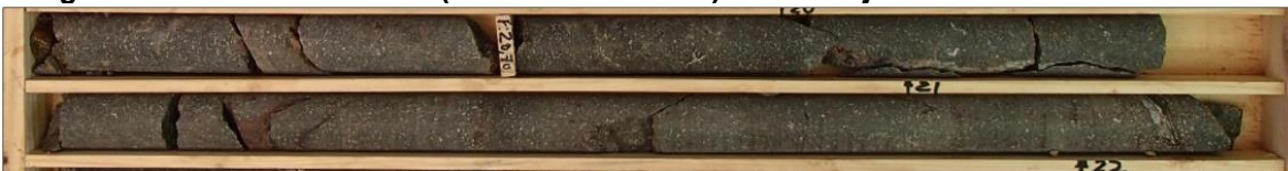
Figura N° 3.1.6.18 Unidad B5 (Andesita Basáltica) de Sondaje DDAR-56C de los 21 a 22m
