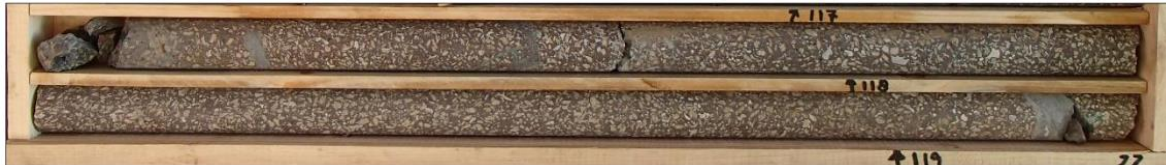
Figura N° 3.1.6.15 Unidad B3 de Sondaje DDAR-56C de los 118 a 119 m
