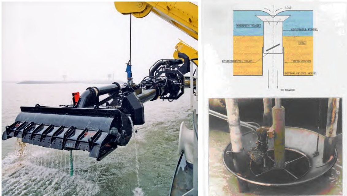
Ilustración 14. Equipamiento de buques-draga
