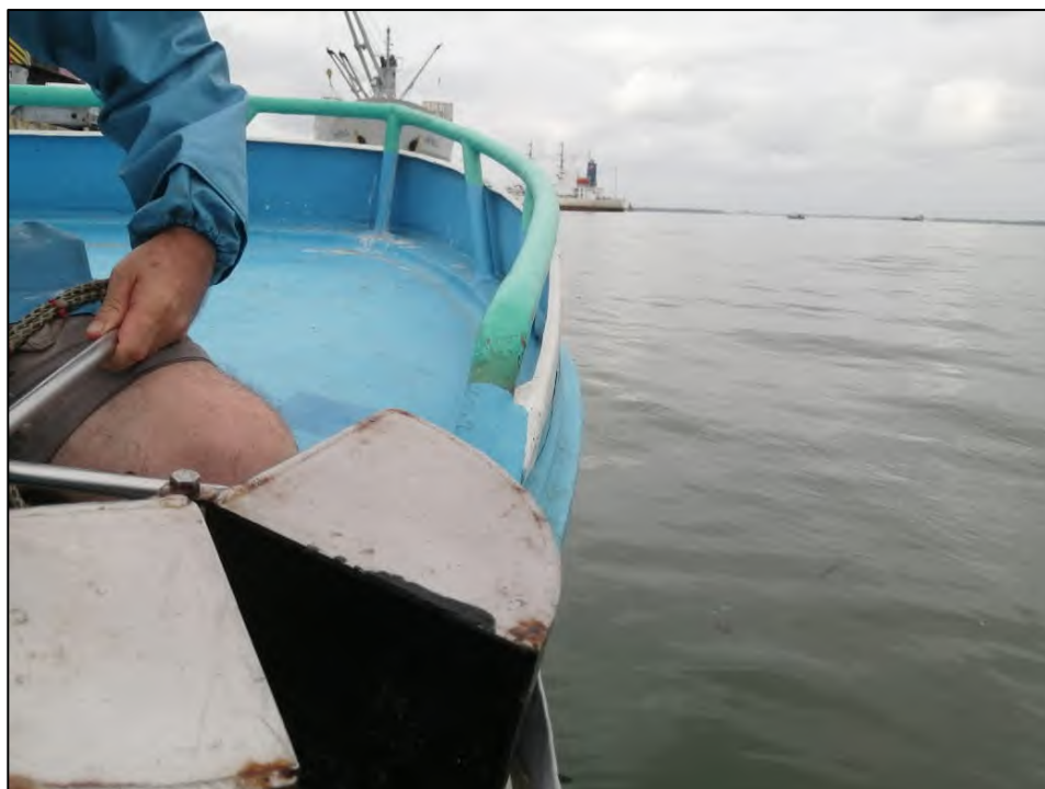
Registro fotográfico 1. Draga Van Been empleada para muestreo bentónico y tamizado de muestras a 500 micras.
