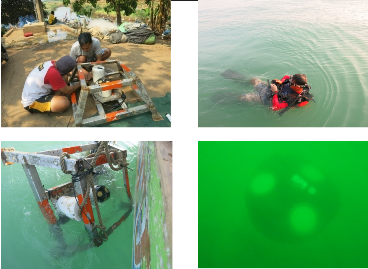
Gambar 2.72. Pengambilan Data Arus dan Gelombang menggunakan ADCP di Perairan Tanjung Jati, Jepara (Sumber : Dokumentasi Lapangan, Oktober 2015)
