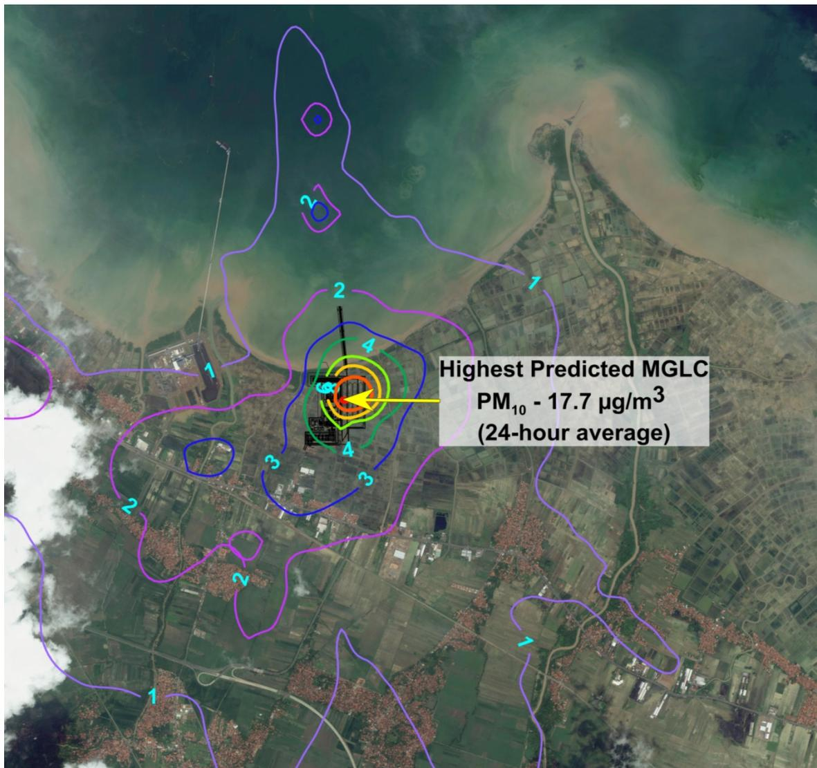
**Gambar 3-29 Hasil pemodelan dispersi PM<sub>10</sub> (rata-rata 24 jam) dari seluruh sumber emisi yang dihasilkan oleh PLTU Cirebon kapasitas 1x1.000 MW (tidak termasuk *background*).**
