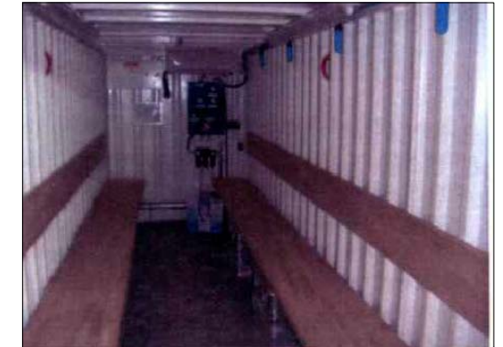
MEDIDAS DE SEGURIDAD. CÁMARA DE ESCAPE O SALVAMENTO EN TUNELADORAS
