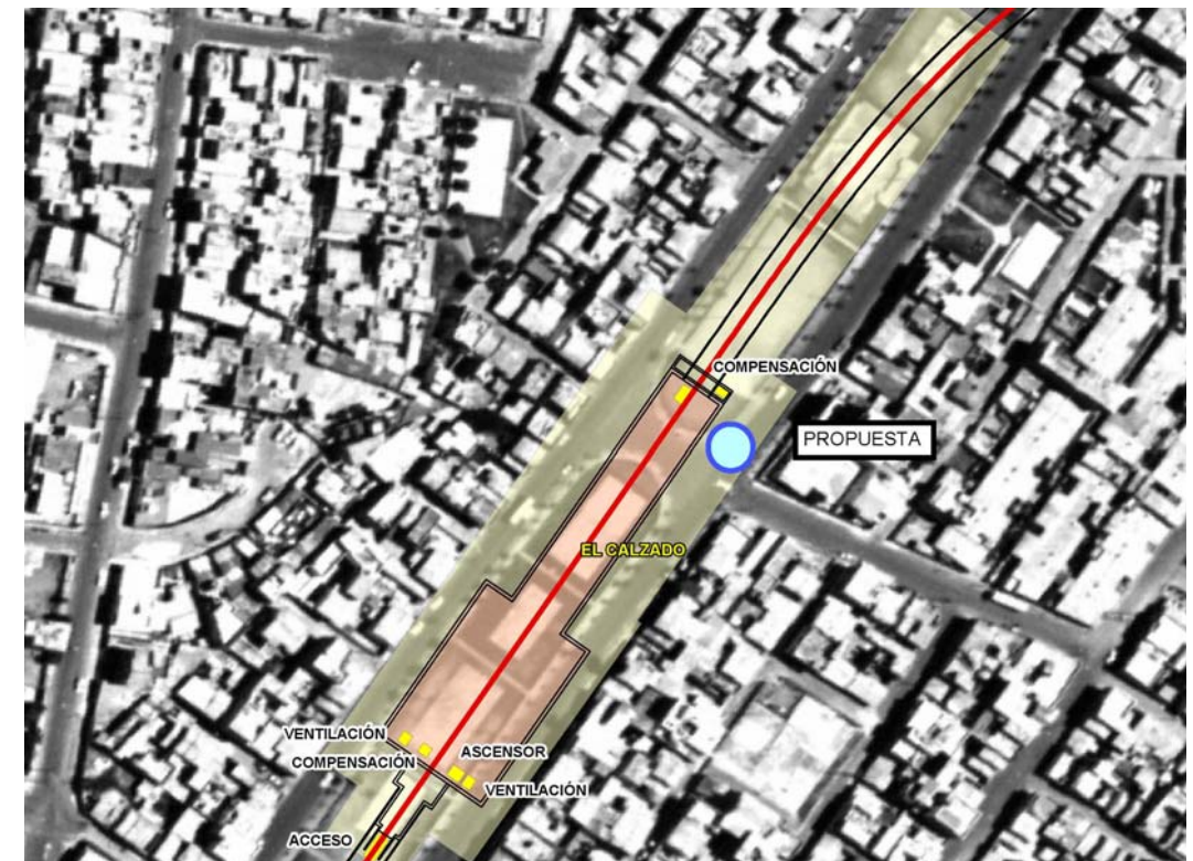
Figura 11.41 Propuesta de ubicación de almacenaje temporal de residuos en la estación de El Calzado
