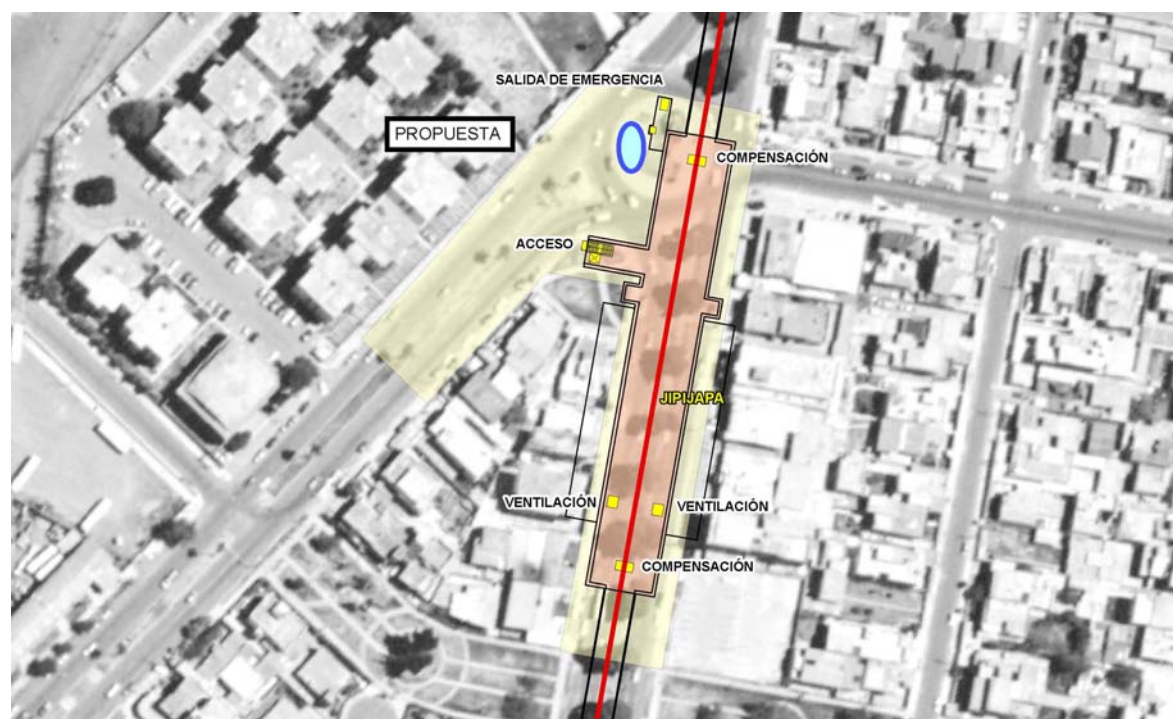
Figura 11.51 Propuesta de ubicación de almacenaje temporal de residuos en la estación de Jipijapa
