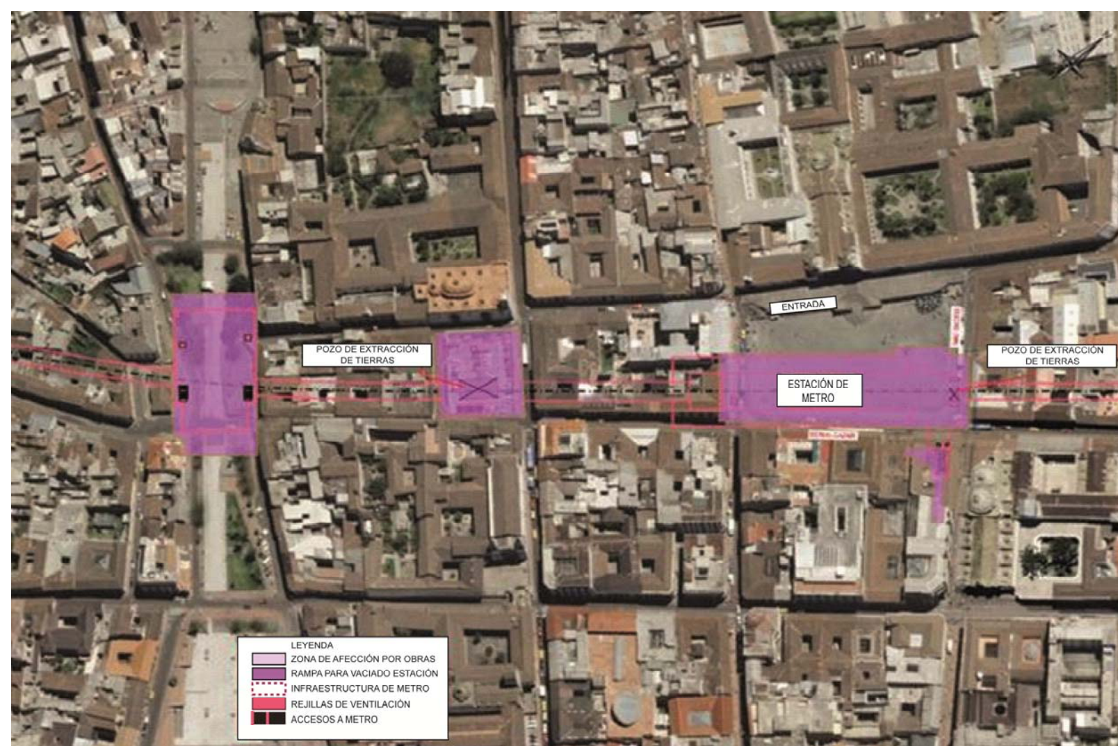
Figura 11.16 Áreas afectadas en estación de San Francisco
