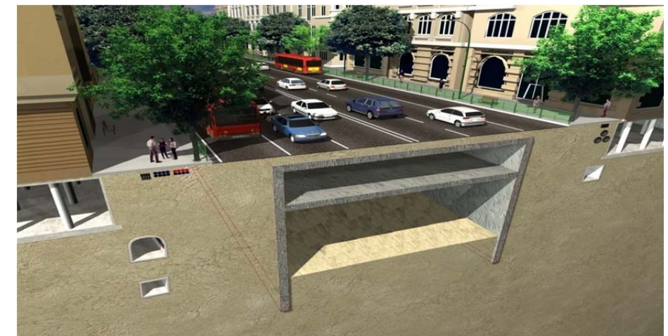
Figura 5.52: Excavación bajo losa (II y III)
