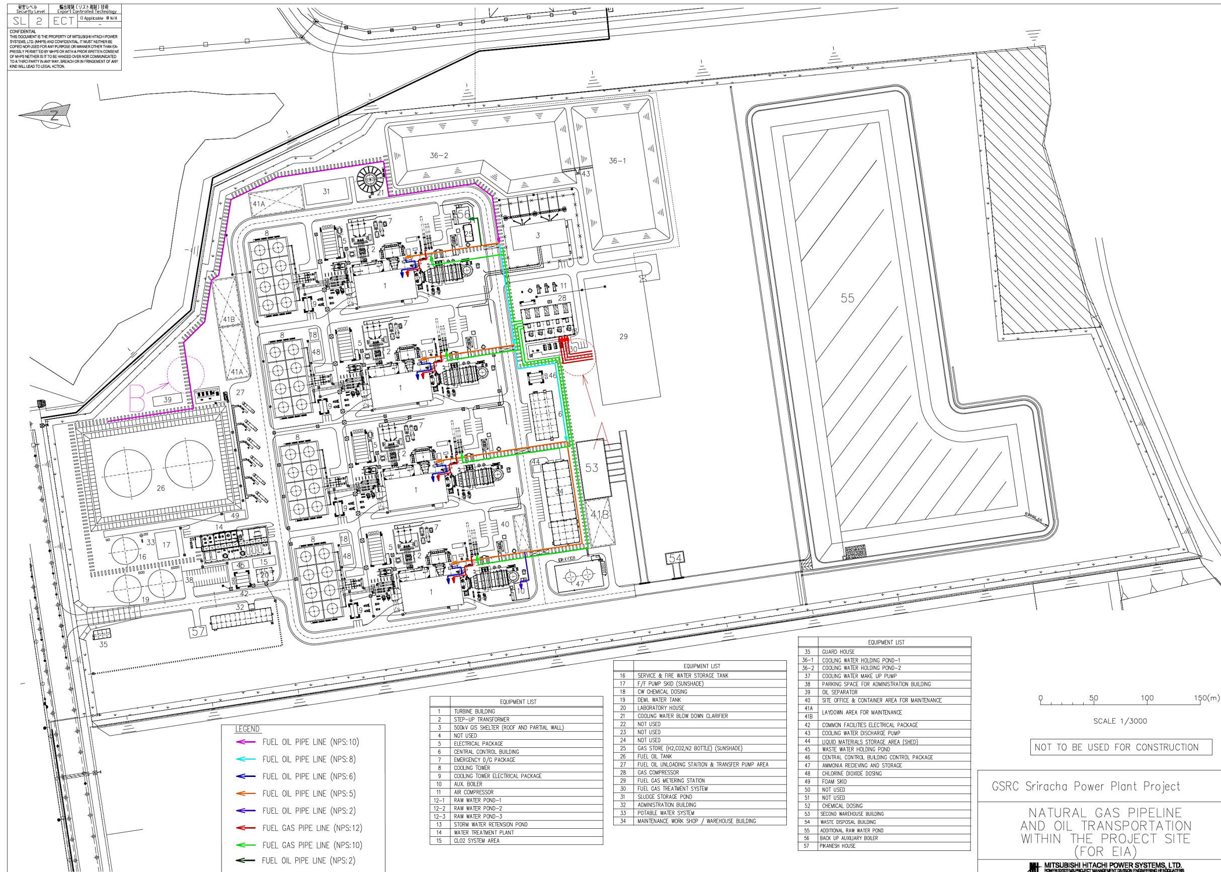
รูปที่ 2.2-3 : แนวท่อส่งก๊าซธรรมชาติและท่อน้ำมันของโครงการ ภายหลังจากเปลี่ยนแปลงรายละเอียดโครงการ
