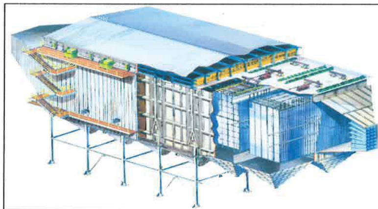
Hình 4-1. Sơ đồ thiết kế ESP điển hình
