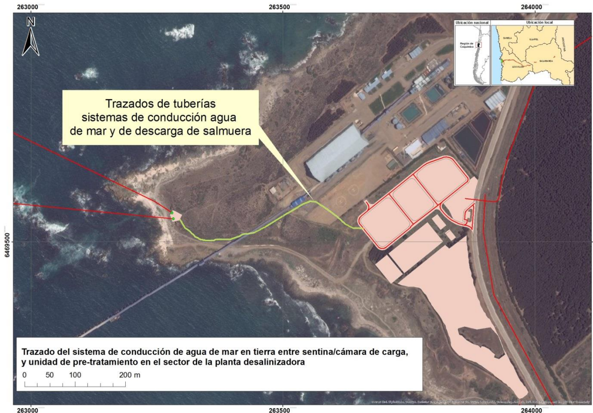
Figura DP-27: Trazado del sistema de conducción de agua de mar en tierra entre sentina y cámara de carga y la unidad de pre-tratamiento en el sector de la planta desalinizadora
