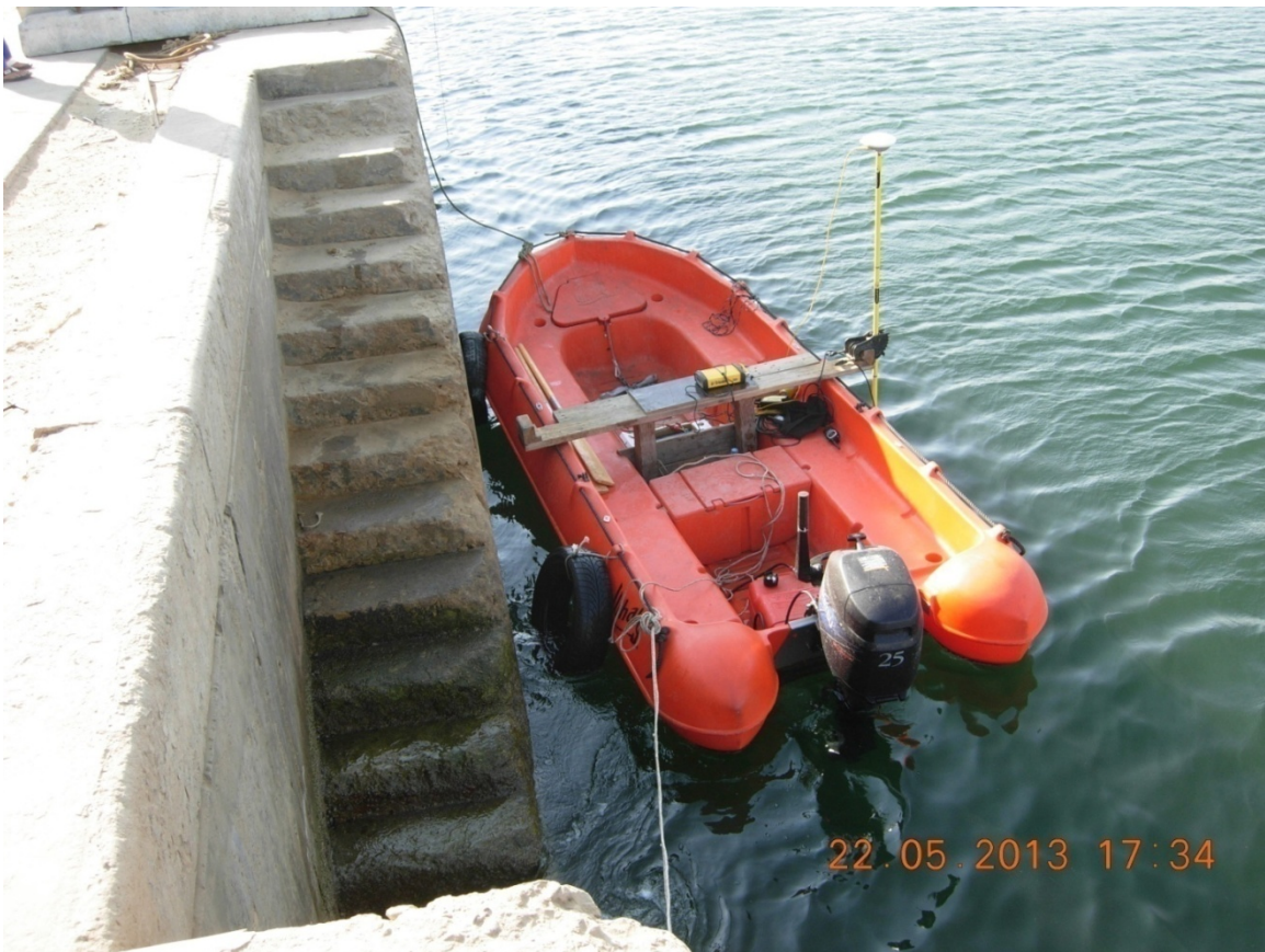
Figura 11 – Embarcação usada no levantamento batimétrico atracada na ponte-cais no Porto de Namibe
