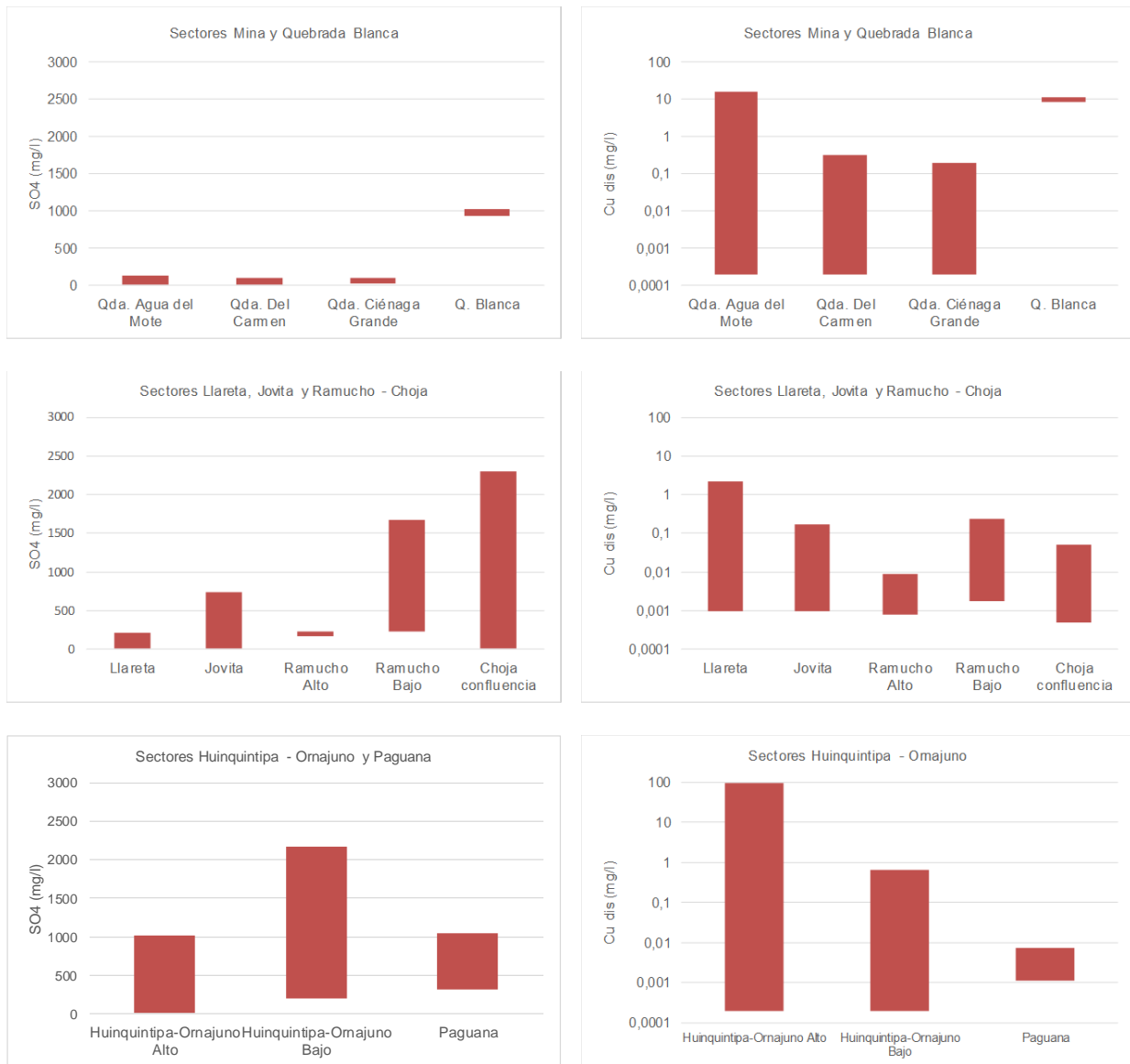
Figura 4-76. Línea Base Calidad de Agua Proyecto Quebrada Blanca Fase 2. Rango de variación de SO 4 y Cu disuelto.
