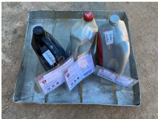
รูปที่ 3-24 ถาดสำหรับรองรับน้ำมันที่จะหกรั่วไหล
