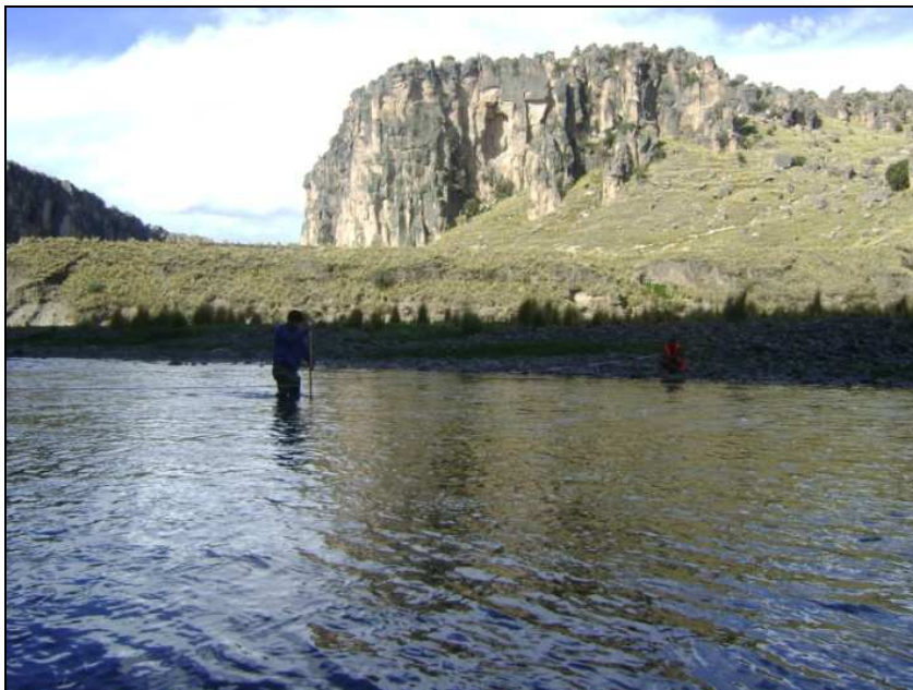
Foto N° 4.2.4-10: Río Apurímac, aforo HI-04A, aguas arriba de confluencia con ríos Cernitambo y Cayo Mani. Zona Tres Cañones. Q=4,09 \text{ m}^3/\text{s} .
