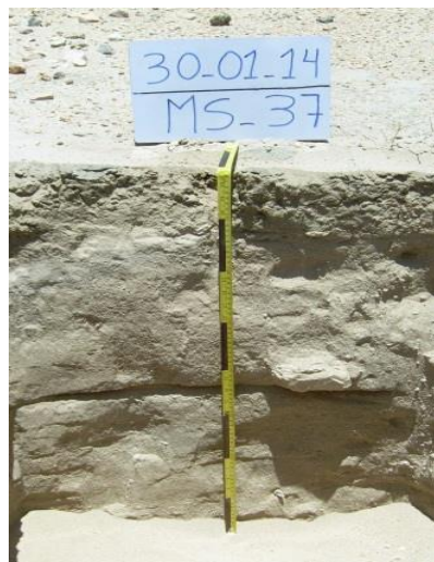
Foto 20. Perfil de suelo Calicata MS-37.
