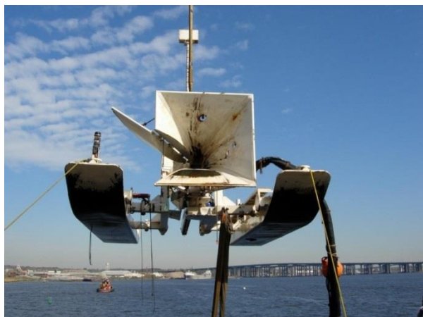
Figuur 4-20: Prysmian Hydroplow Jetting trencher
