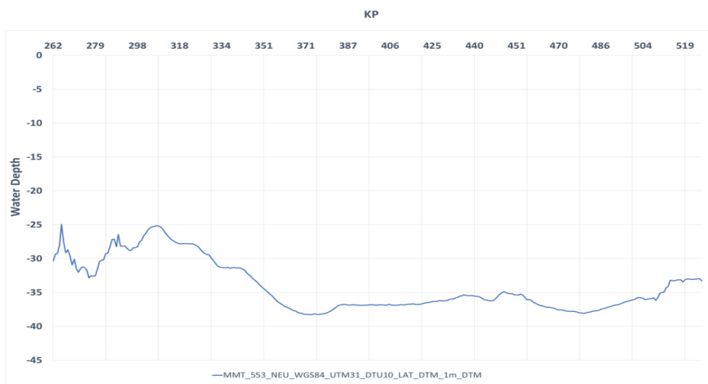
Figuur 8-3: Bathymetrisch profiel langs de NeuConnect kabel
