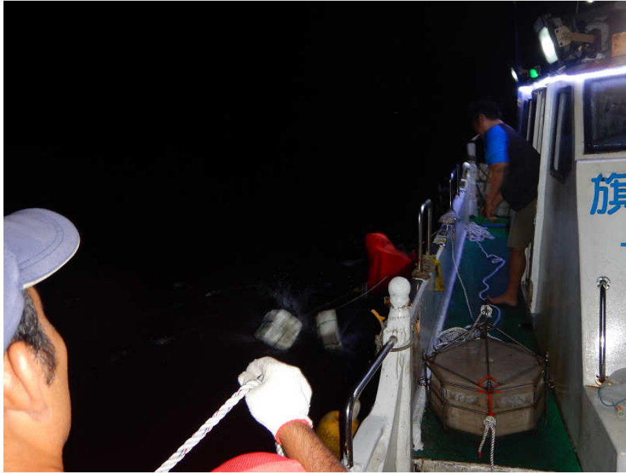
圖A.4 捕砂器投放作業二
