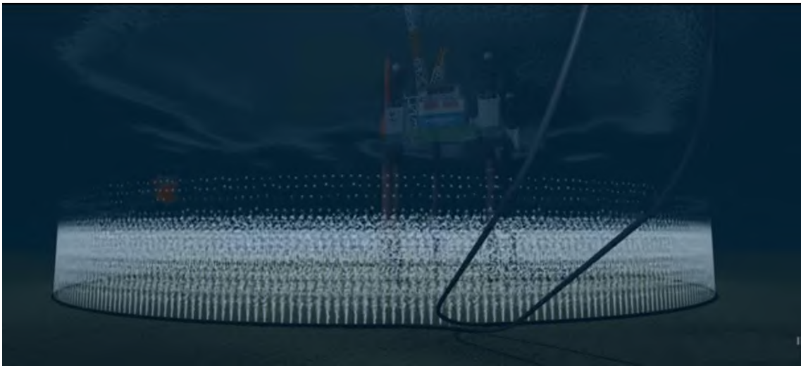
圖 6.1.2-1 氣泡幕減噪工法氣體噴出示意圖
