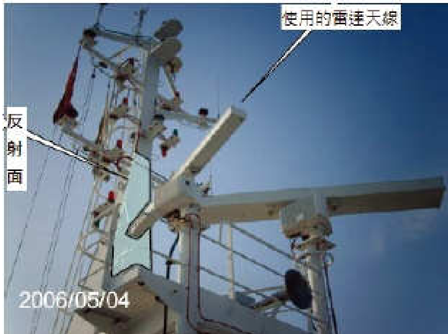
(b) 使用的雷達天線以及造成假回跡的反射面
