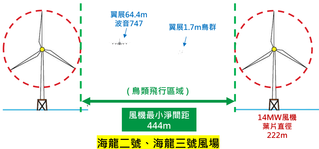
圖 1.8.1-6 依實際風機尺寸按比例尺繪製之風機間距及鳥群大小對照圖(14MW)
