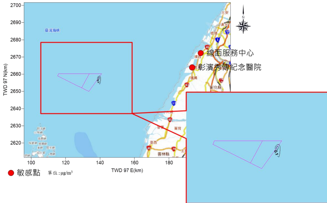
圖 1.9.2-13 本次變更船舶海上作業施工期間 TSP 年平均增量模擬圖
