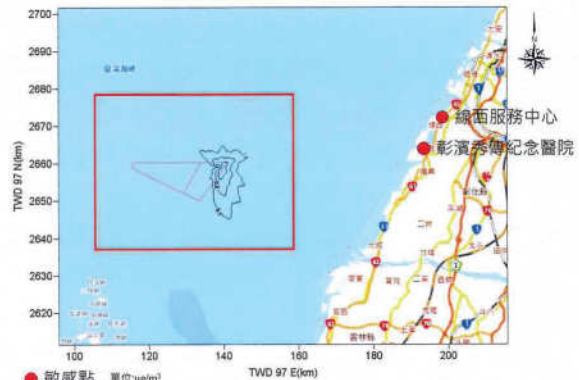
● 敏感點 單位:µg/m 3 海龍三號-船舶海上作業施工期間 TSP最大日平均值增量模擬圖
