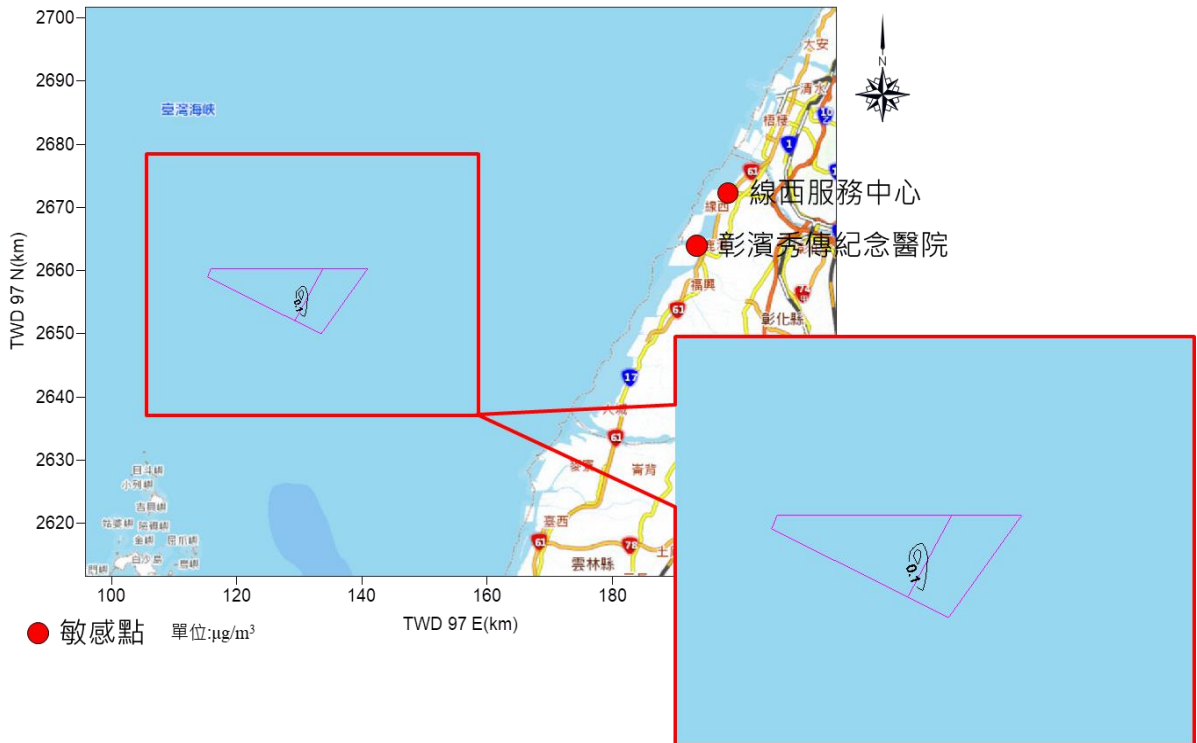
圖 2.11.10-3 本次變更船舶海上作業施工期間 TSP 年平均增量模擬圖
