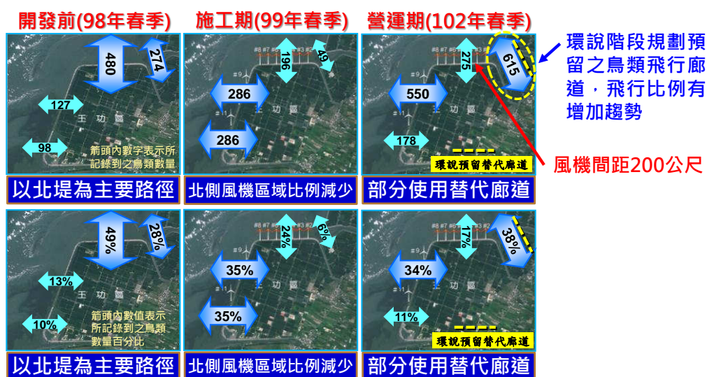
圖 2.18.1-2 王功風力發電站開發前後鳥類飛行路徑變遷概況
