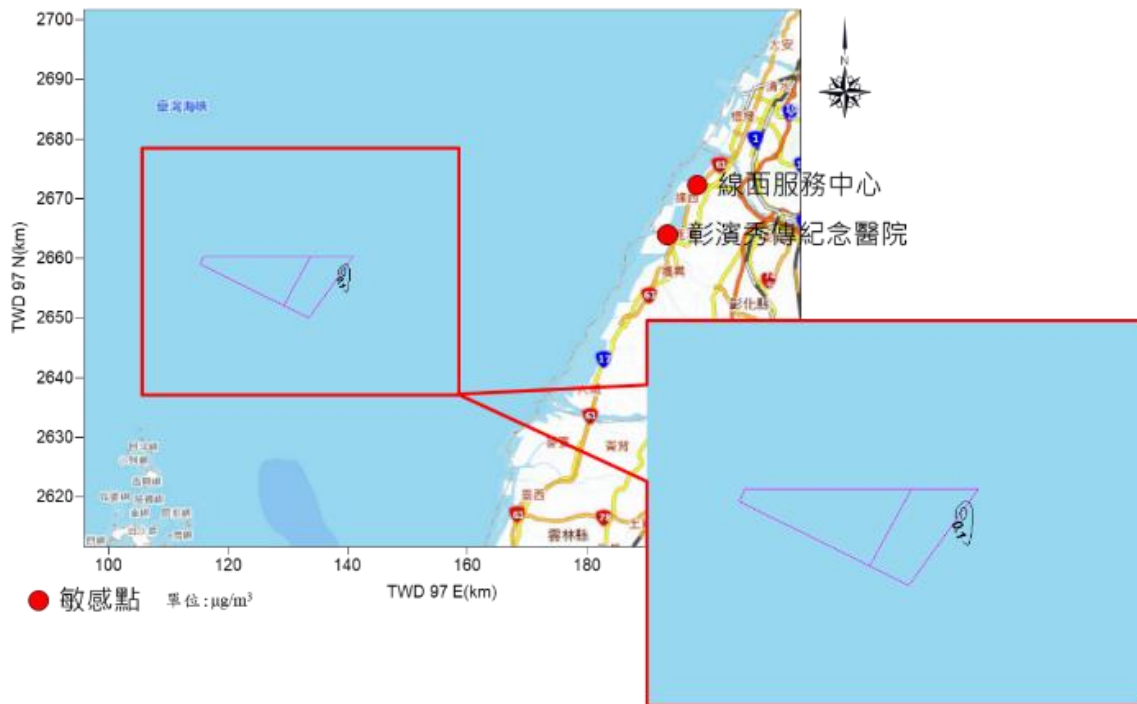
圖 2.2.3-2 本次變更船舶海上作業施工期間 TSP 年平均增量模擬圖
