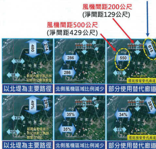
開發前(98年春季) 施工期(99年春季) 營運期(102年春季) 王功風力發電站開發前後鳥類飛行路徑變遷概況 (北堤間距約200公尺，西堤間距約500公尺)
