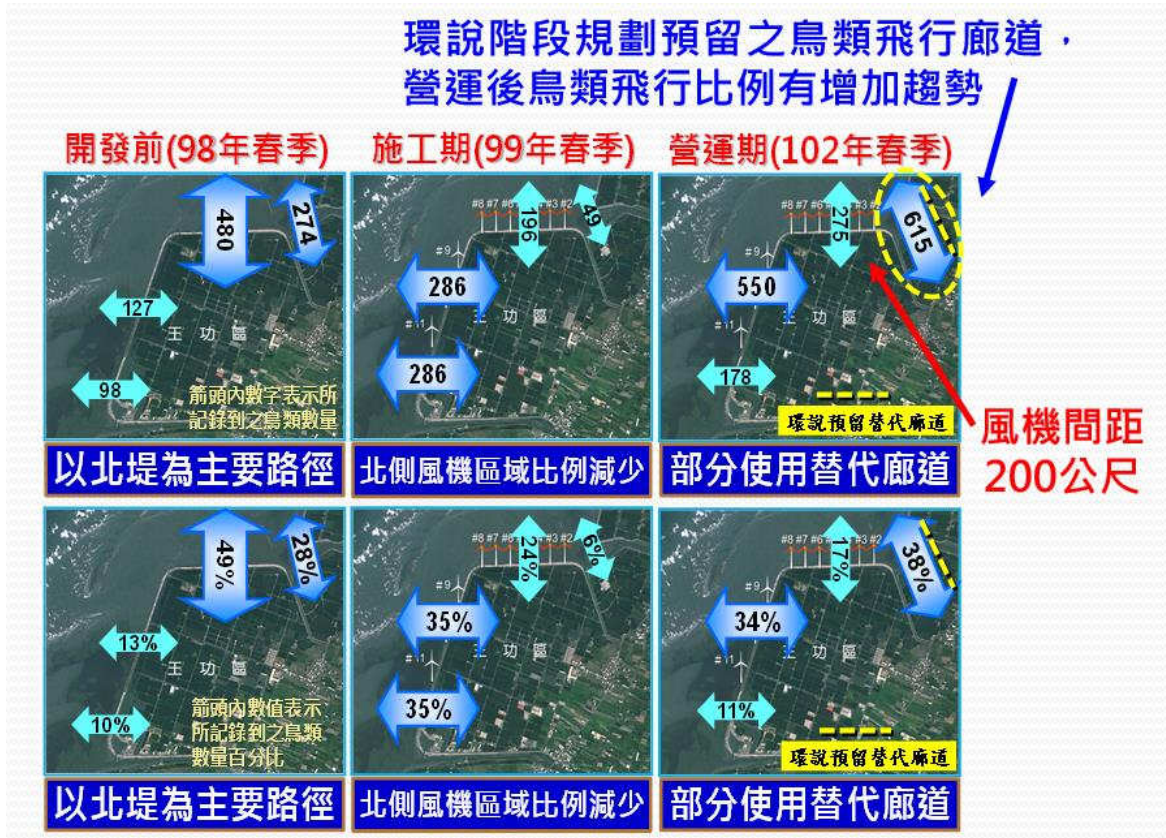
圖 1.4.1-6 王功風力發電站(北側間距約 200 公尺)開發前後鳥類飛行路徑(施工前、施工期間、營運期間)
