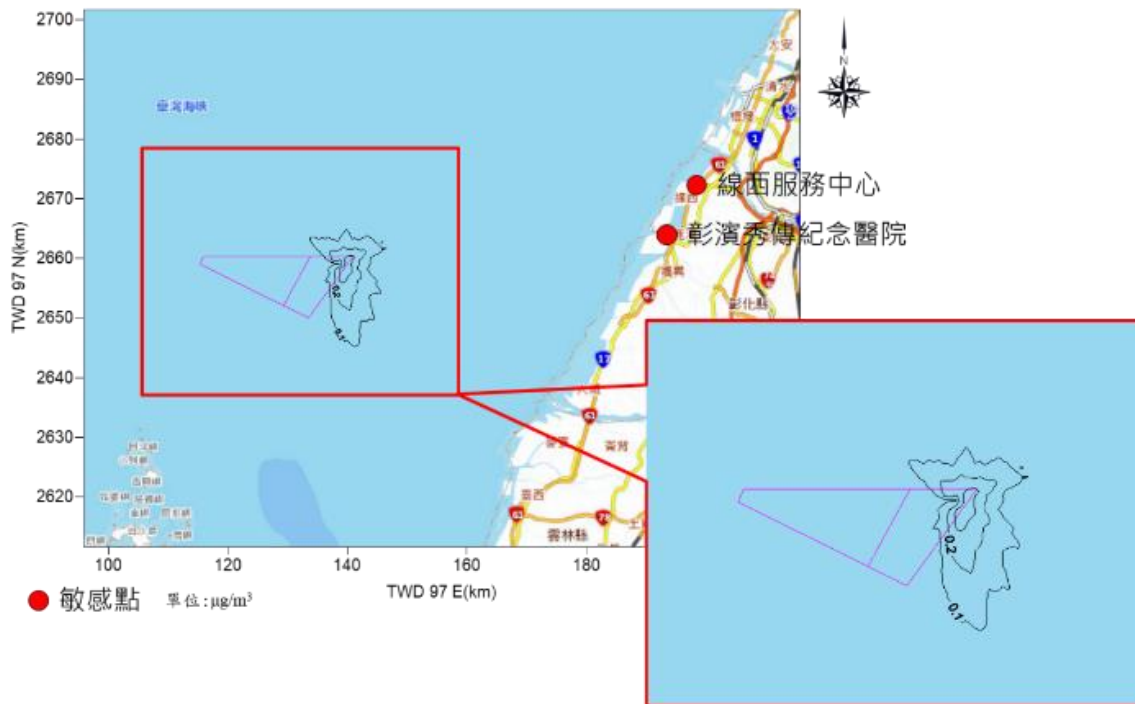
圖 2.11.4-3 本次變更船舶海上作業施工期間 TSP 最大日平均值增量模擬圖
