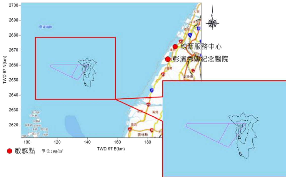
圖 2.11.5-1 本次變更船舶海上作業施工期間 TSP 最大日平均值增量模擬圖
