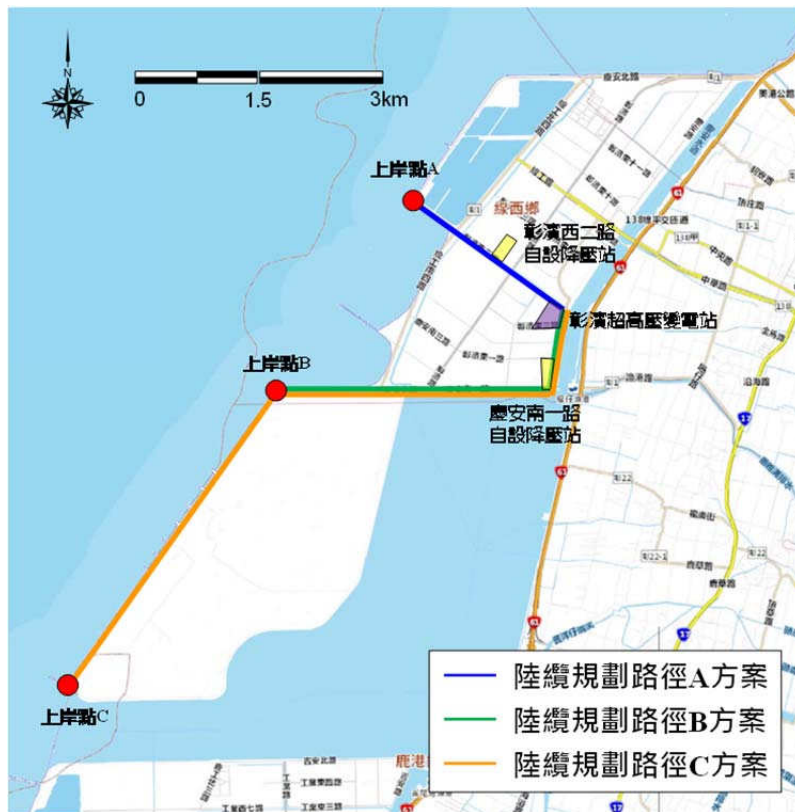
圖 1.8.2-2 本計畫可能上岸點及其陸纜路徑示意圖 (海龍二號及海龍三號採共構規劃；三方案擇一，共用陸纜)
