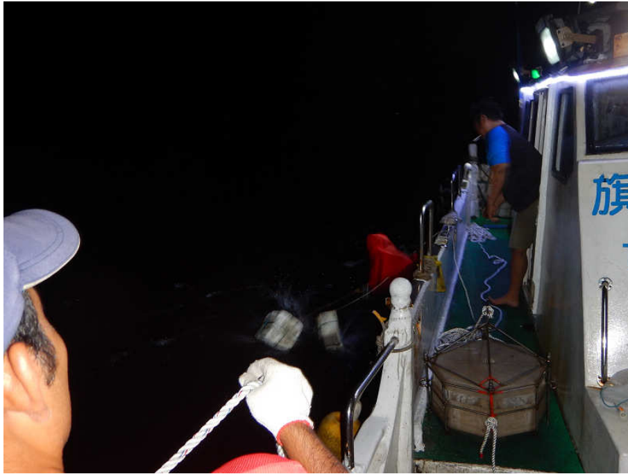
圖A.4 捕砂器投放作業二
