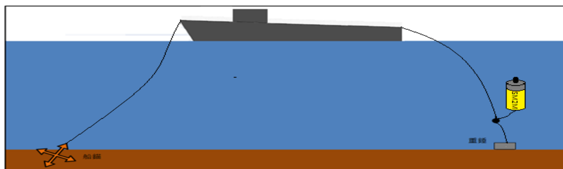
圖 4 水下噪音量測儀器佈放示意圖
