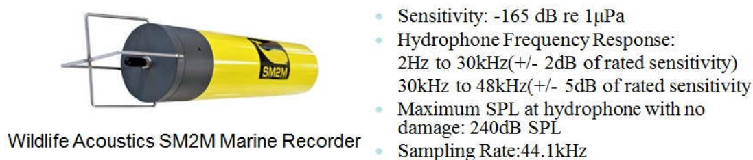
圖 3 SM2M 儀器外觀與規格圖
