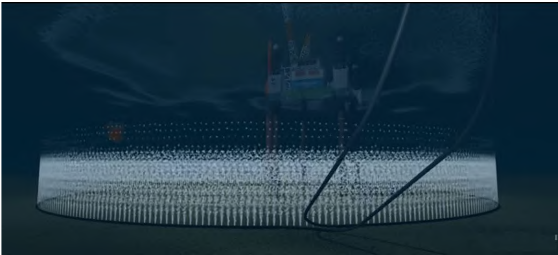
圖 6.1.2-1 氣泡幕減噪工法氣體噴出示意圖
