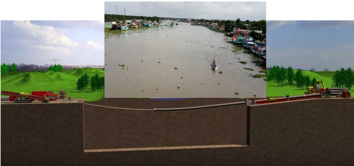
Hình 3.15 Thi công qua Kênh/rạch bằng phương pháp khoan xiên
