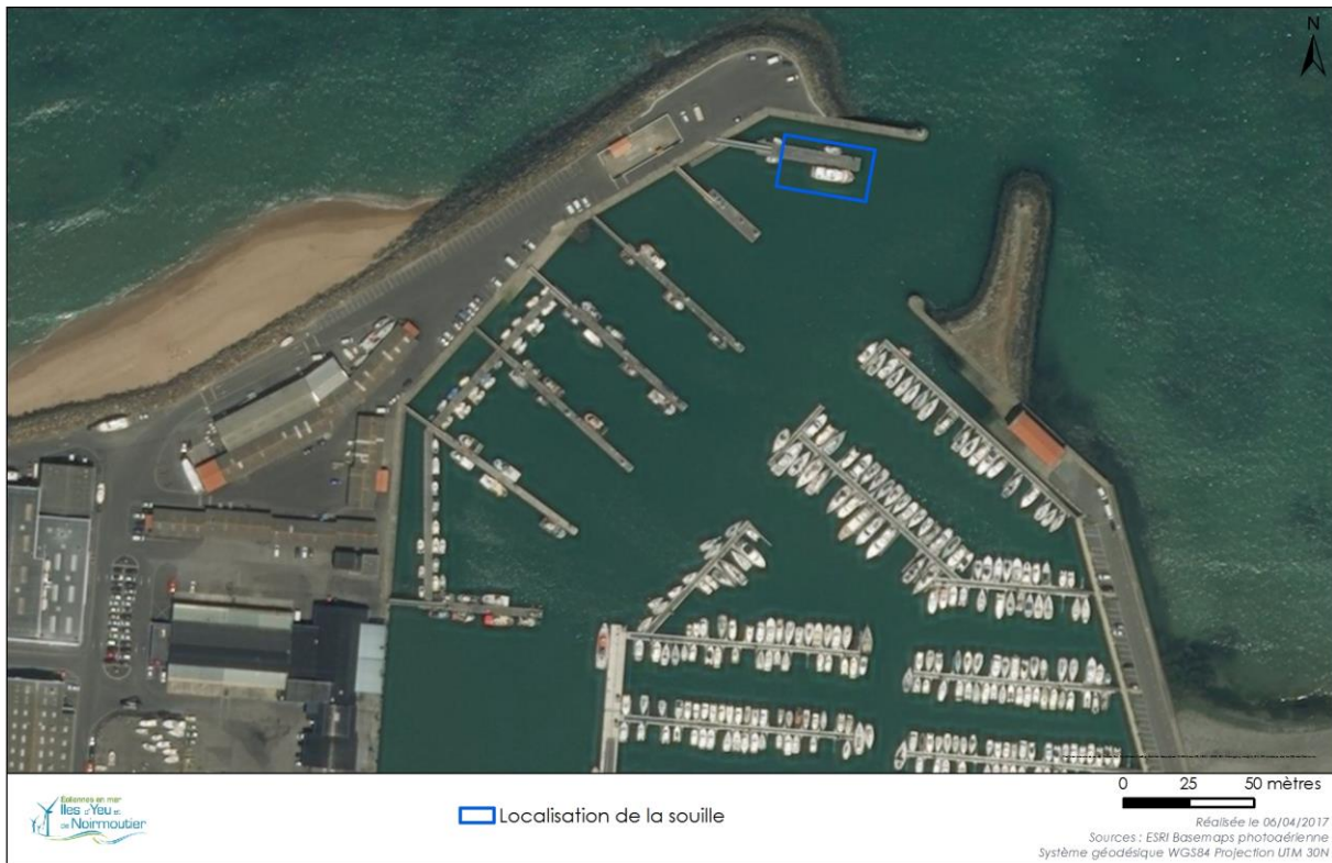
Figure 10 : Zone de déroctage à 3,0 m CM délimitée en bleu
