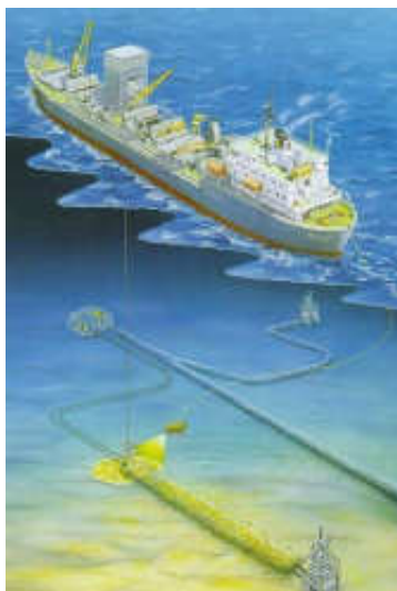
Figure 42 : Moyen maritime pour le placement des roches sur un câble
