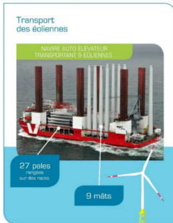
Figure 21 : Transport des éoliennes
