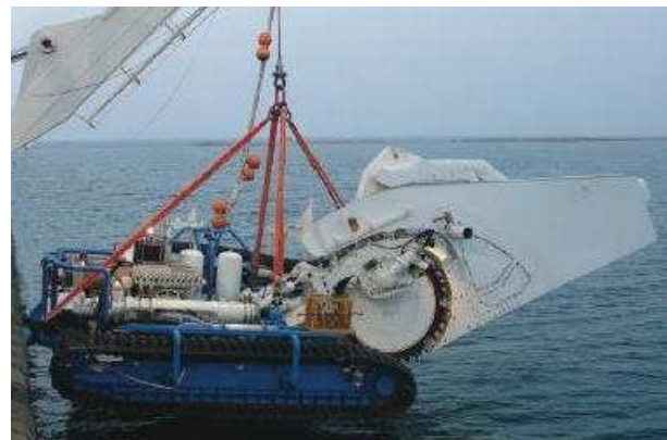
Photographies 24 : Illustrations des outils utilisés pour l'ensouillage
