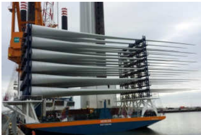
Photographie 16 : Système de maintien des pales pour le transport
