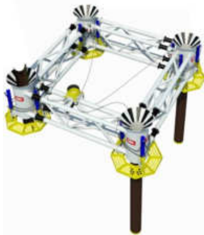
Figure 8 : Cadre permettant l'installation des pieux d'une fondation Jacket
