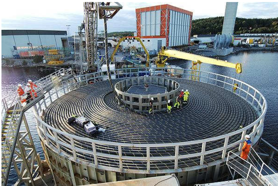
Photographie 11 : Câble sur un navire câblier
