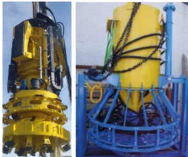
Photographies 5 : Tête de forage rotative
