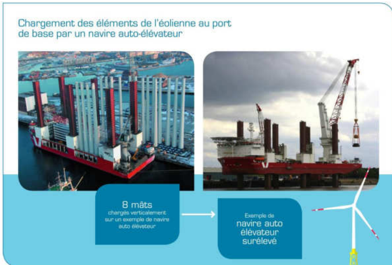
Figure 20 : Chargement des éléments de l'éolienne au port de maintenance lourde par un navire auto-élevateur
