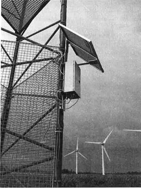
Figure 5: Exemple de système de protection du microphone (potence acier)
