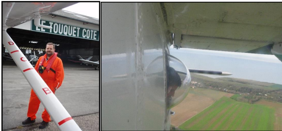
Figure 9 : Matérialisation des couloirs sur les haubans du Cessna et "bubble window" du BN2
