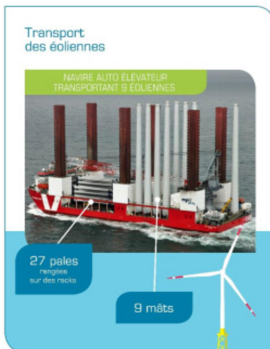
Figure 44 : Transport des éoliennes
