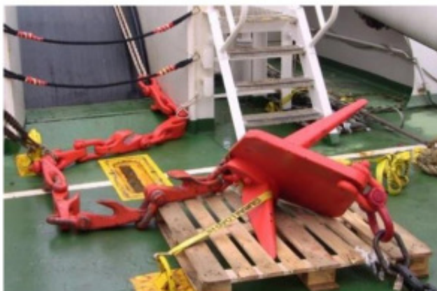
Figure 92 : Grappin pour enlever les débris
