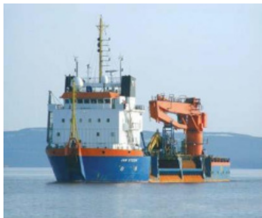
Barge Crane Vessel (source : Van Oord)
