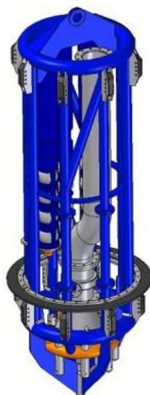
Figure 63 : Outil inséré à l'intérieur d'un pied de fondation pour une découpe interne
