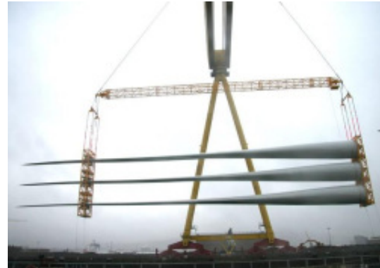
Déchargement de pales déjà séparées (www.modulift.com)
