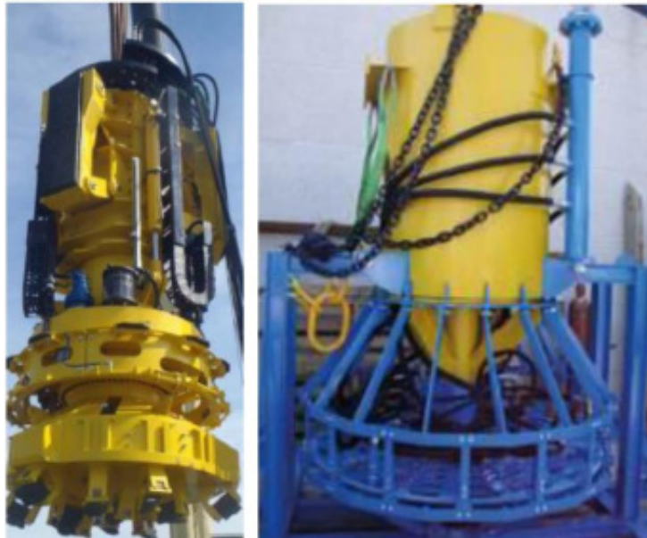
Figure 32 : Tête de forage rotative
