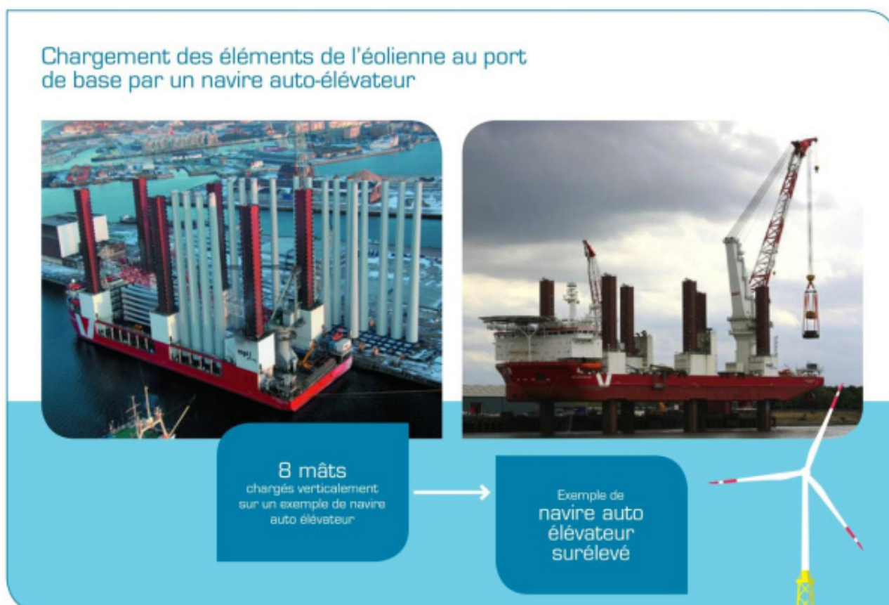
Figure 42 : Chargement des éléments de l'éolienne au port de maintenance lourde par un navire auto-élévateur
