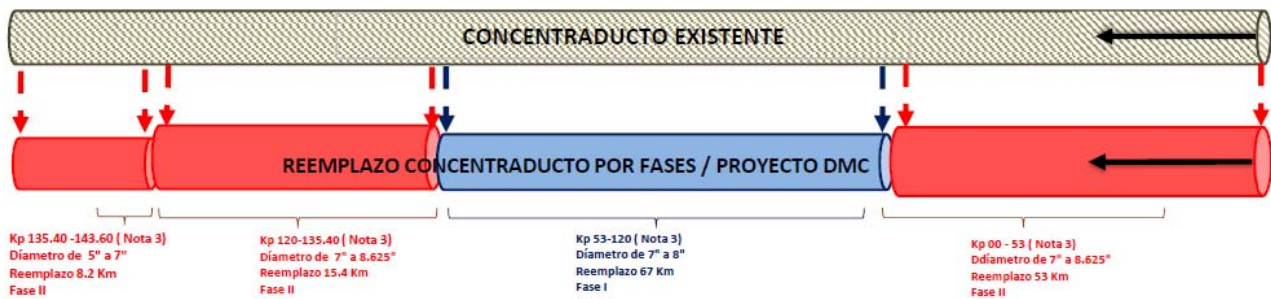
Figura 1-49. Modificaciones sistema de transporte de concentrado
