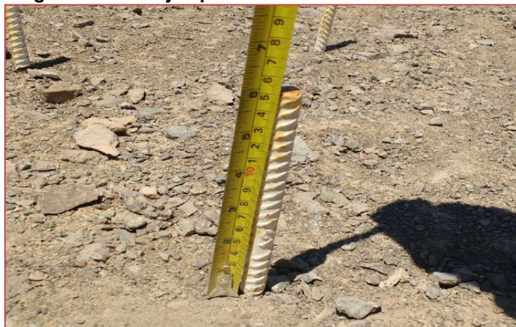
Figura N°145.2 Ejemplo de medición clavos de erosión
