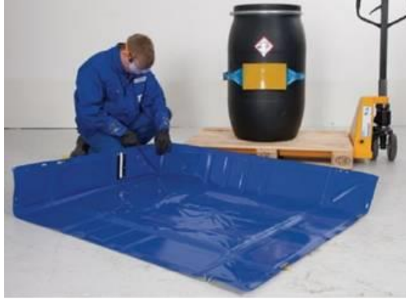
النطاق البلاستيكي لمراقبة تسرب مواد التشحيم وغيرها من السوائل
