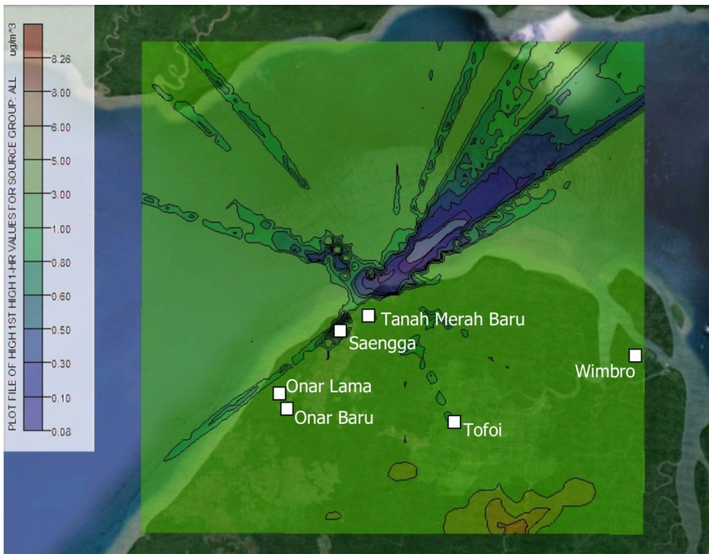
Gambar 4.19 Prakiraan Sebaran Konsentrasi Partikulat Rata-rata 1 Jam ( \mu\text{g}/\text{m}^3 ) dari Kegiatan Operasional Proyek Pengembangan Tangguh LNG dengan Memperhitungkan Topografi ( Elevated Terrain )
