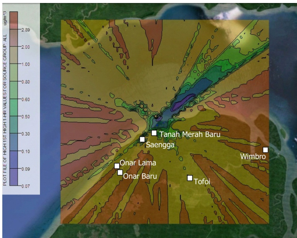
Gambar 4.20 Prakiraan Sebaran Konsentrasi Partikulat Rata-rata 1 Jam ( \mu\text{g}/\text{m}^3 ) dari Kegiatan Operasional Proyek Pengembangan Tangguh LNG tanpa Memperhitungkan Topografi ( Flat Terrain )
