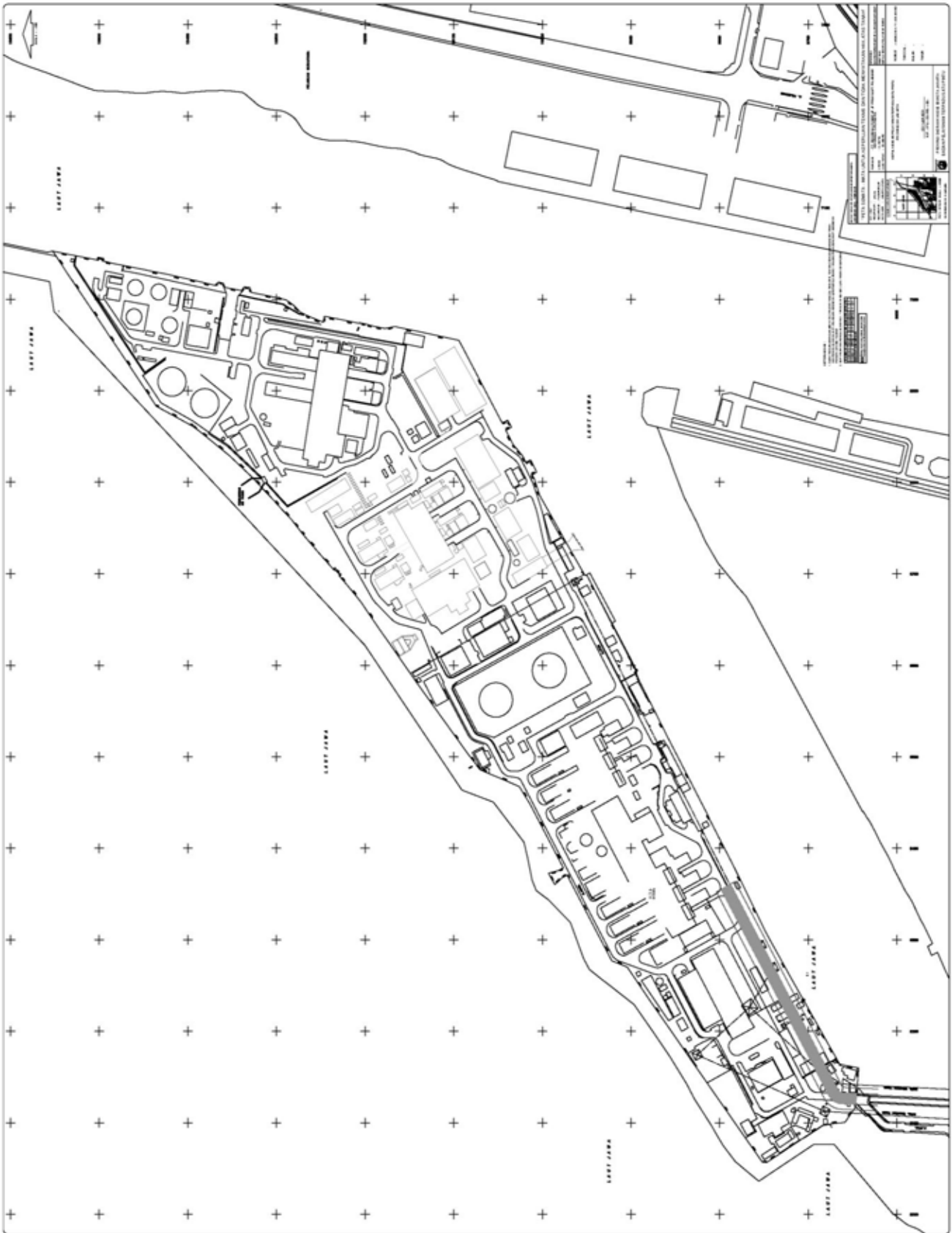
Gambar 1.10 Tata Letak Komponen PLTGU Blok I/II – 1180 MW, Rencana PLTGU Jawa-2 (800 MW) & PLTGU Blok III – 720 MW
