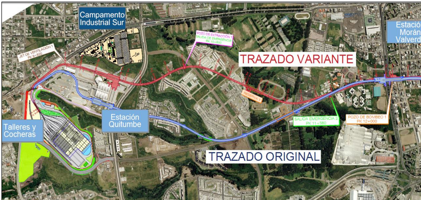
Ilustración 3-1 Trazado de la Variante Quitumbe de 2.6 km., de la Primera Línea del Metro de Quito
