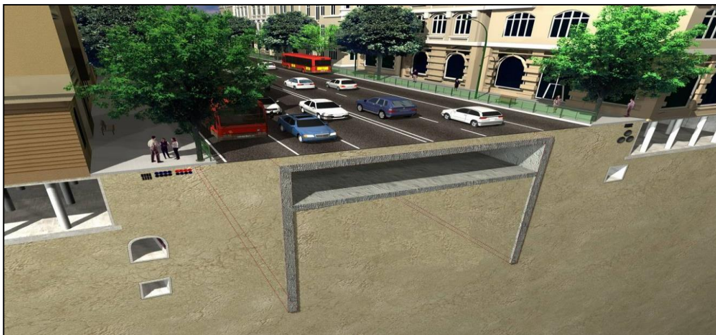
Ilustración 3-18 Excavación bajo losa (I)
