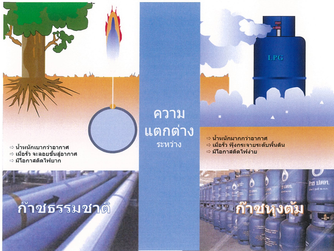
รูปที่ 6.2-6 : ตัวอย่างความแตกต่างเมื่อเกิดการรั่วไหลระหว่างก๊าซธรรมชาติและก๊าซหุงต้ม
