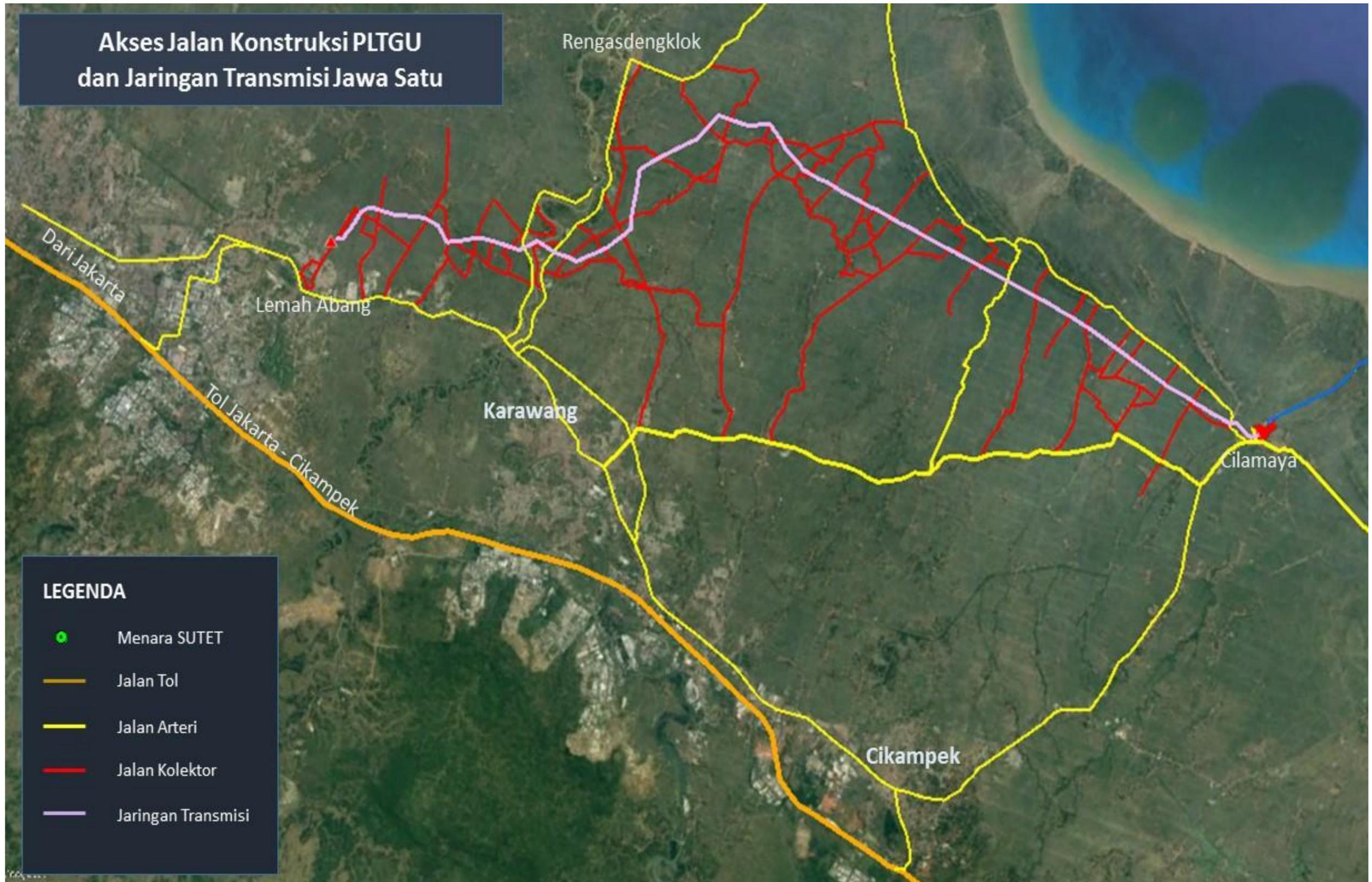
Gambar 1-17 Akses Jalan Konstruksi PLTGU dan Jaringan Transmisi
