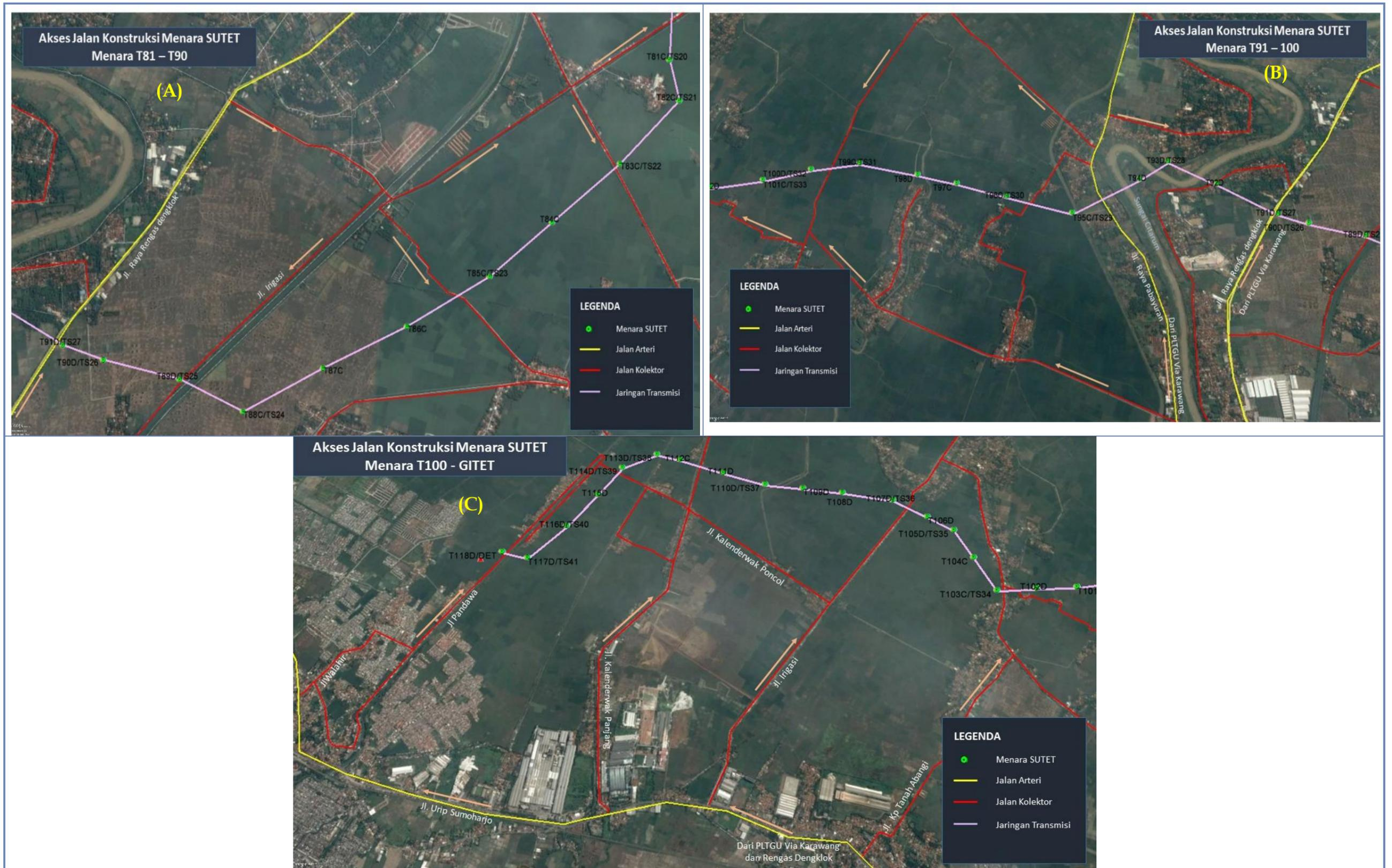
Gambar 3-15 Akses Jalan Konstruksi Jaringan Transmisi (A) Tower T81-T90; (B) Tower T-91-T100; (C) Tower T100-GITET Cibatu Baru II/Sukatani 500 kV
